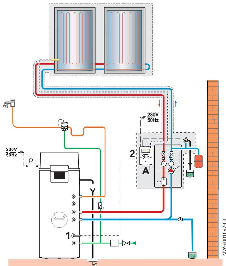
**A** Regolazione del collettore solare
