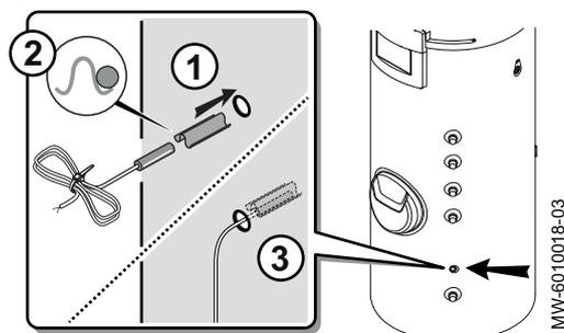
1. Posizionare il sensore nel pozzetto portasonde, utilizzando l'apposito separatore.
