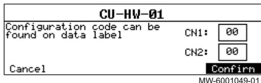
5. Impostare i parametri **CN1** e **CN2**. I valori sono riportati sulla targa matricola dello scaldacqua della pompa di calore. Vengono, inoltre, elencati nella tabella seguente. Questi parametri sono accessibili anche dopo la messa in servizio:
