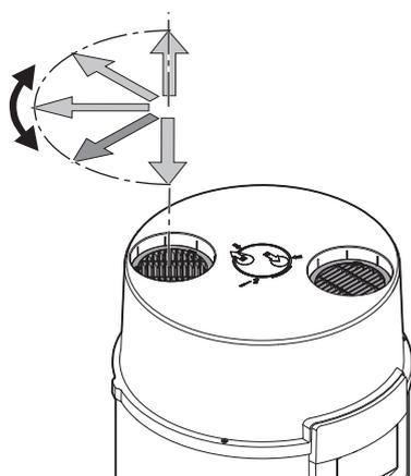
Non rimuovere le griglie fornite per l'installazione con aria ambiente (non canalizzata).
