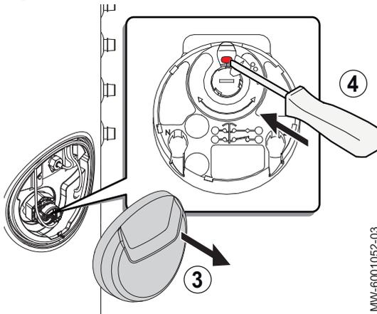
All'interno del termostato di sicurezza è integrato un interruttore di sicurezza. Esso evita che l'acqua venga nuovamente riscaldata nel caso si verificasse un surriscaldamento accidentale. Eliminare la causa del surriscaldamento, quindi resettare il termostato di sicurezza.
